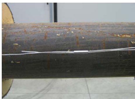
3. Posizionare i fili nel morsetto serrafili
